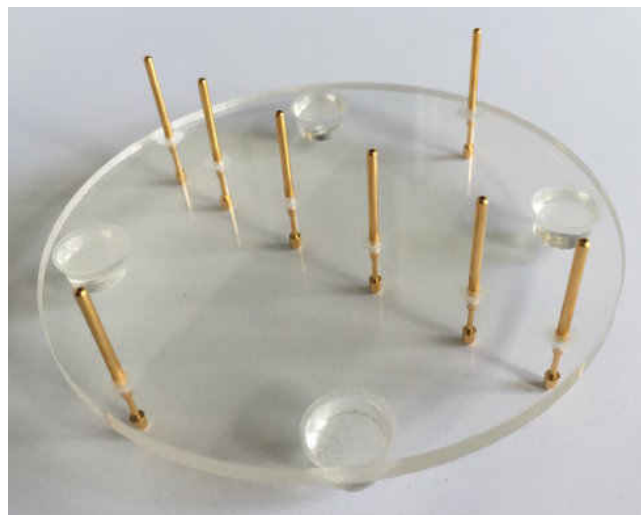
Слика 2: Држач за M4T мерења са четири гумене ножице и осам контаката (места за прикључивање сонди).
