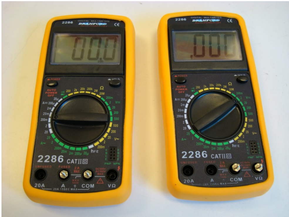
Слика 2.3 Мултиметри са прикључцима који омогућавају да се користе редом као амперметар ( лево ) и волтметар ( десно ). Мултиметар се укључује притискањем дугмета “POWER” у горњем левом углу. Инструмент се аутоматски искључује ако га неко време не користите. Може да мери једносмерну струју и напон (=), као и наизменичну струју и напон (~). Унутрашња отпорност волтметра је 10 MΩ у сваком мерном опсегу. Напон на амперметру је једнак 200 mV када амперметар читава максималну струју датог мерног опсега. Ово важи за сваки мерни опсег. У случају прекорачења максималне вредности датог мерног опсега, на екрану ће се појавити “1” и тада је потребно изабрати већи мерни опсег. Дугме “HOLD” (горњи десни угао) не треба притискати јер ће у том случају на екрану остати вредност мерења из тренутка кад сте притиснули дугме.
