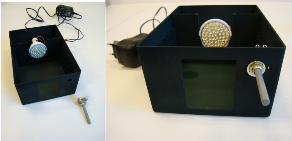
Слика 2.2 (а) Кутија са извором светлости и отпорником који треба поставити. (б) Отпорник постављен у кутији. Отпорник треба поставити у одговарајући отвор и причврстити матицом са подлошком. Притом мала избочина у облику зуба треба да стане у мањи отвор који се налази поред главног отвора у који се ставља отпорник.
