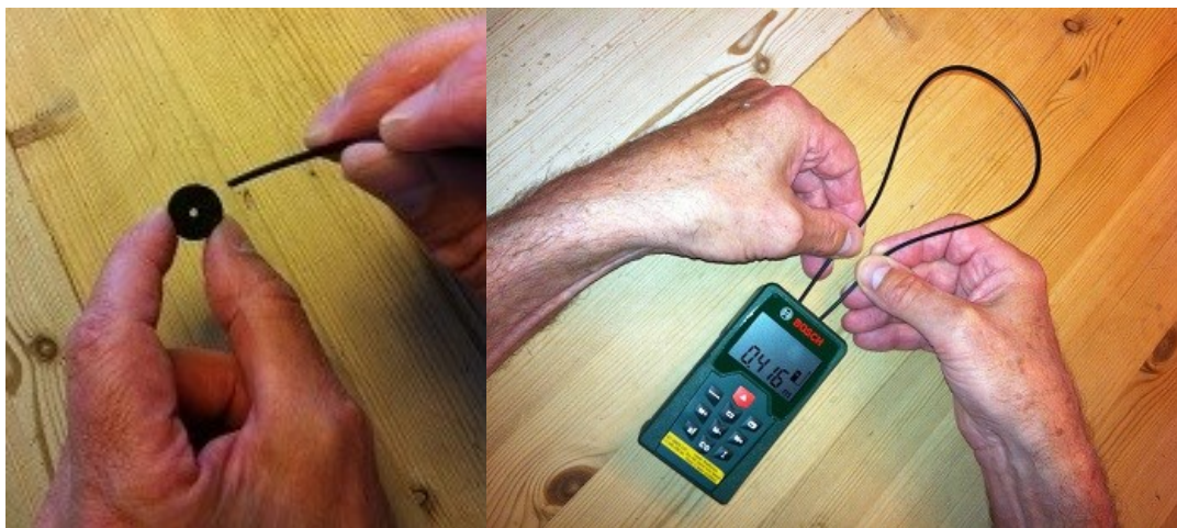
Слика 1.5 (а) Филцани подметач и оптички кабал. (б) Постављање оптичког кабла.
