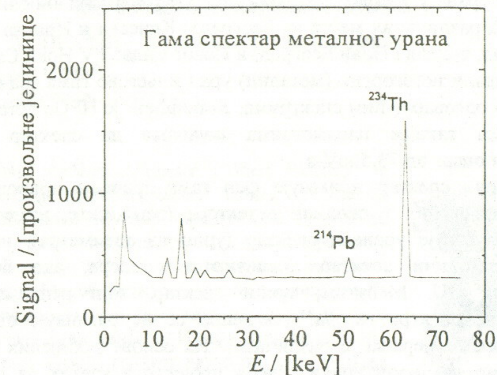
Слика 2. Гама спектар металног урана који показује како би изгледао спектар гелера који садржи ОУ. Појављивање сигнала ^{234}\text{Th} је сигуран показатељ присуства ^{238}\text{U} у узорку.
