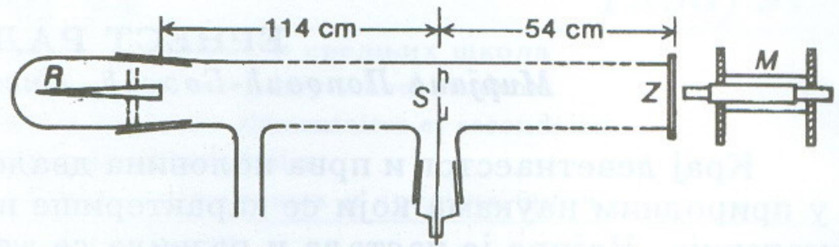
Слика 1. Гајгерова првобитна апаратура, за посматрање расејања алфа-честица из извора  $R$  на фолији  $S$ . Алфа-честице које падају на заклон  $Z$  су посматране оком кроз микроскоп  $M$ .
